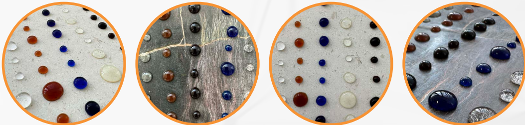
Ejemplo real de resistencia a distintos tipos de manchas: aceite, café, vinagre, azul de metileno... Estas piedras han sido protegidas con Tecnadis PRS Performance.
